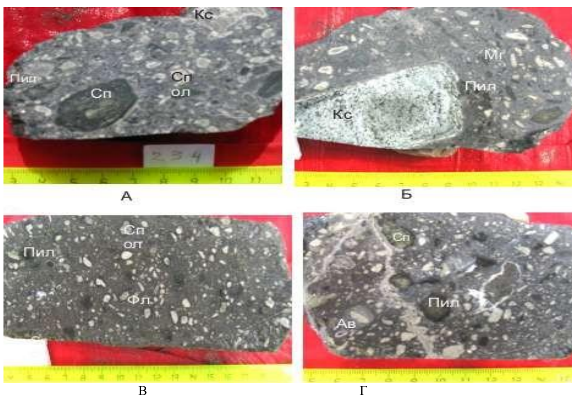
Рис. 1. Текстурно-структурные особенности кимберлитовых пород трубки Манчаары. Сп-серпентинит; Кс — ксенолит осадочной породы; Пил — пикроильменит
