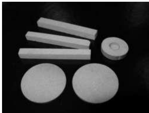
Рис. 1. Керамические образцы для механических и электрофизических испытаний.
