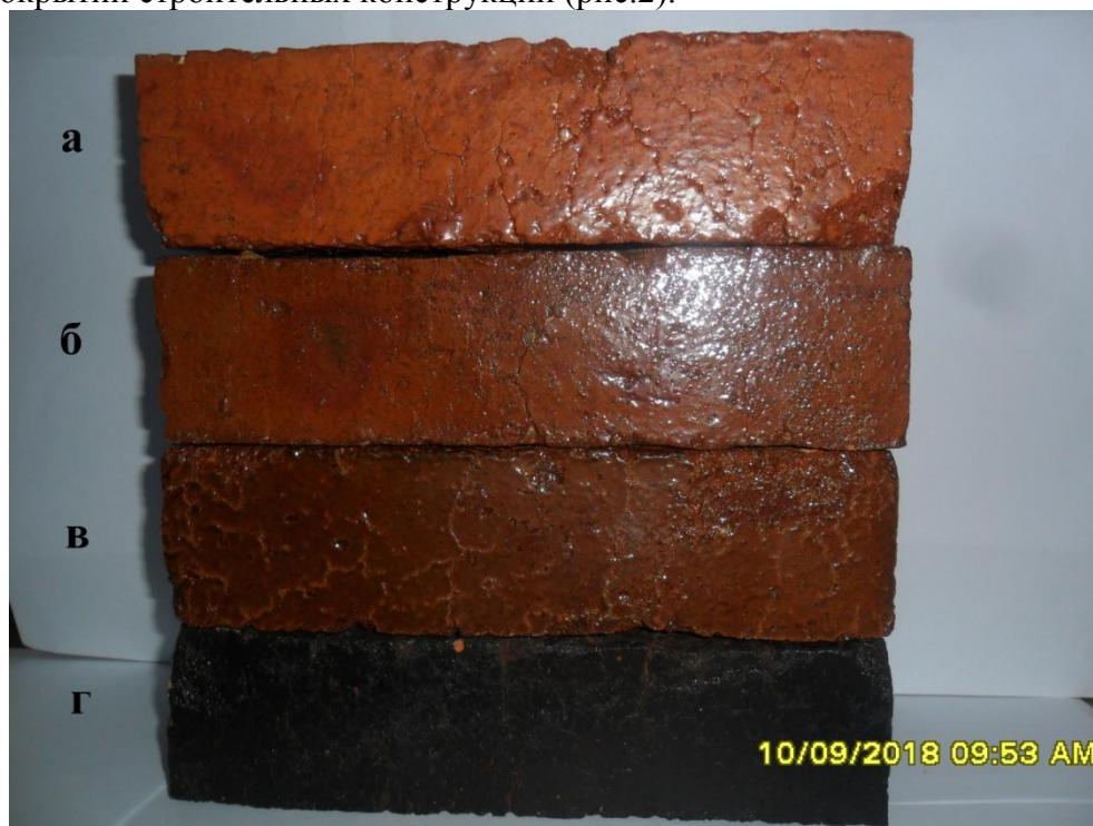
Рис.2. Порошковое напыление на керамические кирпичи. Состав: связующее вещество - бесцветный лак (50%), наполнитель (50%) - а) кварцевый песок; б) зола уноса; в) топочный шлак г) магнитная фракция.
