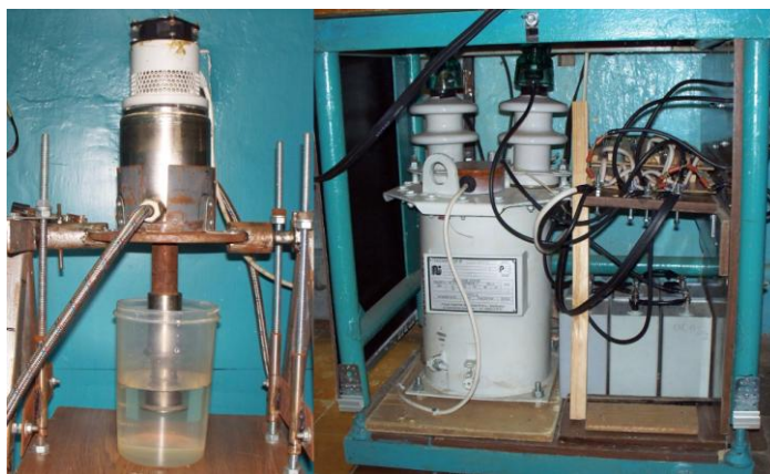
Рис. 1. Рабочий узел ультразвуковой установки и силовая часть электроискровой установки
