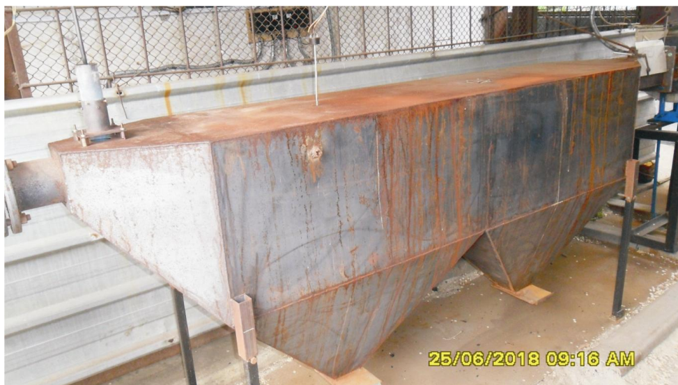
Рис. 2. Золуловитель с камерой дожига.
