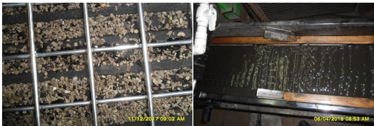
Рис. 2. Выделения неорганических примесей из исходных углей на опытной шлюзовой установке.
