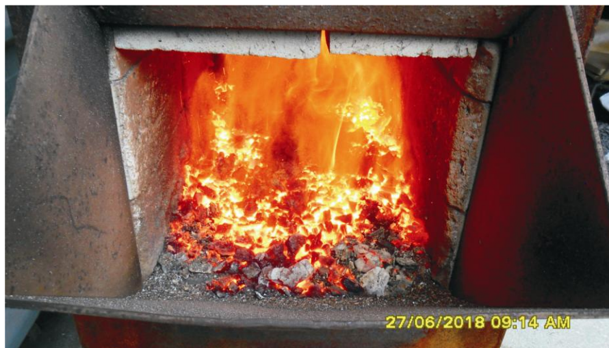
Рис. 1. Сжигание топлива в режиме кипящего слоя.
