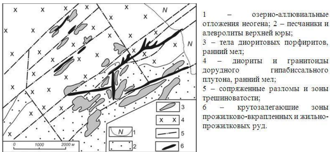
Рис. 2. Схема геологического строения месторождения Пионер, по [7] с упрощениями.
