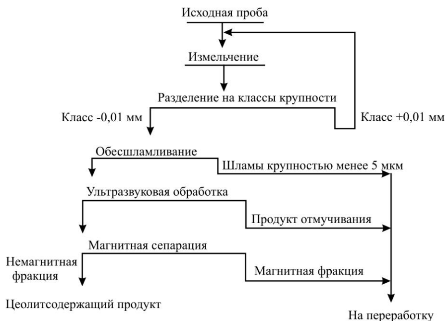
Рис. 1. Схема обогащения цеолитсодержащего сырья
