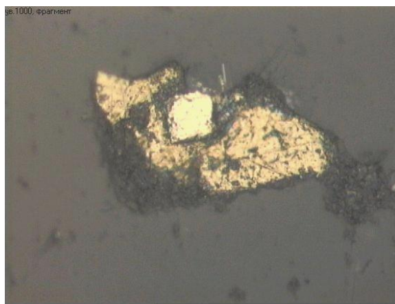
Рис.6. Хадакристал (фромбоид) арсенопирита (квадратной формы) в более позднем пирите, содержащем сармиентит, развитый по эмульсионным вкраплениям \text{FeAsS}_2
