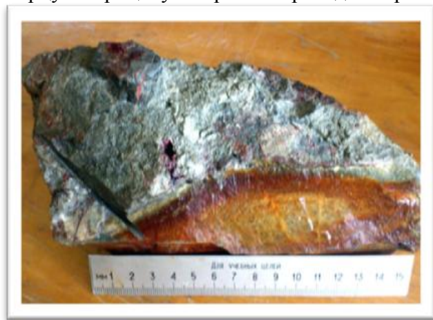
Рис. 1. Обильное выделение золотосодержащих сульфидных минералов вдоль кварцевой жилы проходящей между диабазом и граносиенитами. Они в виде вкраплений, гнезд и прожилка приурочены к окварцованному габбро-диабазу. На контакте кварцевой жилы с габбро-диабазом развиты гидроокислы железа желтого цвета и марганца красного цвета.
