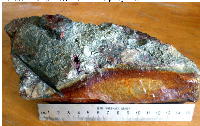
Рис. Обильное выделение золотосодержащих сульфидных минералов вдоль кварцевой жилы проходящей между диабазом и граносиенитами. Они в виде вкраплений и гнезд прурочены к окварцованному габбро-диабазу. На контакте кварцевой жилы с габбро-диабазом развиты гидроокислы железа желтого цвета и марганца красного цвета.
