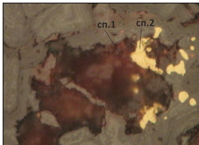
Рис.1 Выделение самородного золота в сульфидах и гидроокислах железа (x100)
